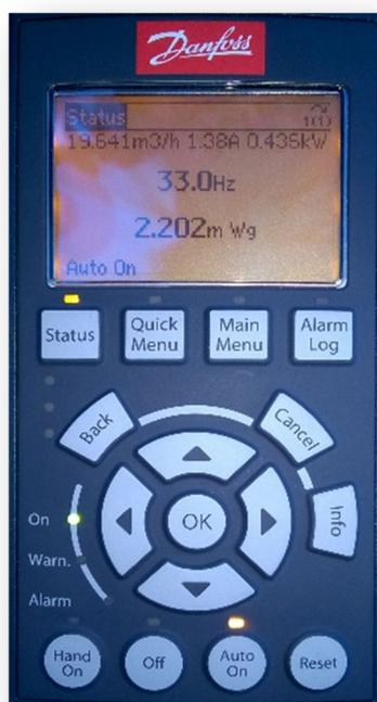
Parametriranje frekvenčnega pretvornika se izvede samo z zaslonom LCP 102, tabelo za sensorless se lahko naloži samo z programom MCT 10. Parametriranje lahko v celoti izvedete z MCT 10.
