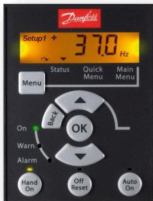
Parametriranje frekvenčnega pretvornika se izvede samo z zaslonom LCP11.
