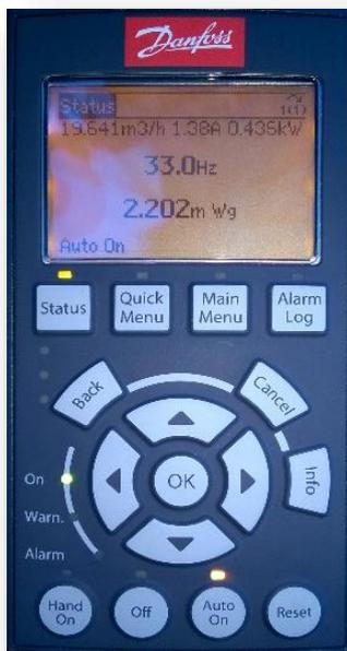
Parametriranje frekvenčnega pretvornika se izvede samo z zaslonom LCP102, tabelo za sensorless se lahko naloži samo z programom MCT 10. Parametriranje lahko v celoti izvedete z MCT 10.
