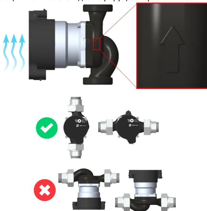
Для установки головки насоса в требуемое положение поверните ее (допустимые положения показаны на рисунке выше). Головка крепится к гидравлическому литому корпусу с помощью четырех винтов. Открутив четыре винта, вы можете повернуть головку насоса. При повторной сборке убедитесь, что уплотнения установлены надлежащим образом. Невозможность обеспечить герметичность уплотнения может привести к утечке воды и повреждению внутренних деталей насоса.
