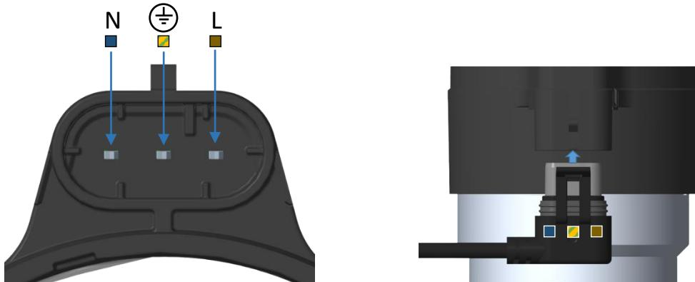
PWM-сигнал подключается через разъем TE Superseal-mini. На рисунках ниже показано, как выполняются электрические соединения.
