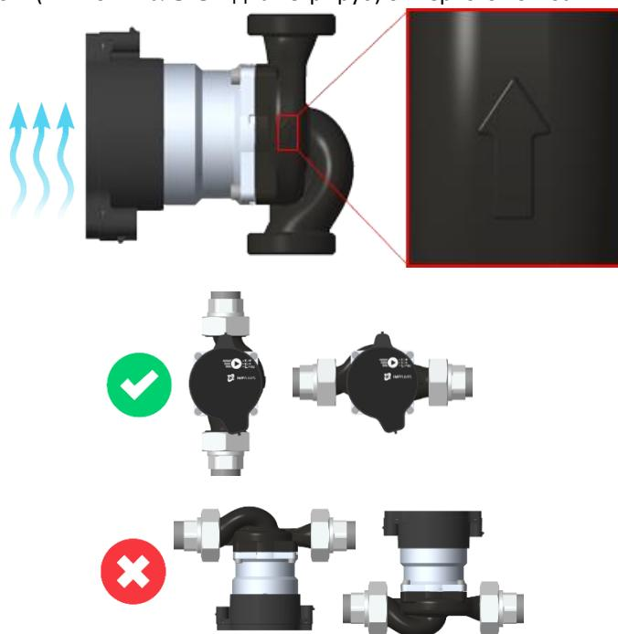
Для установки головки насоса в требуемое положение поверните ее (допустимые положения показаны на рисунке выше). Головка крепится к гидравлическому литому корпусу с помощью четырех винтов. Открутив четыре винта, вы можете повернуть головку насоса. При повторной сборке убедитесь, что уплотнения установлены надлежащим образом. Невозможность обеспечить герметичность уплотнения может привести к утечке воды и повреждению внутренних деталей насоса.
